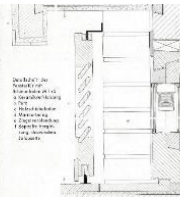
Abb. 252: Landhaus am Lago Maggiore, 1964. Links Ansicht, rechts Schnittzeichnung. Schiebläden und zusätzlich im Luftzwischenraum der Doppelverglasung Fensterläden.
